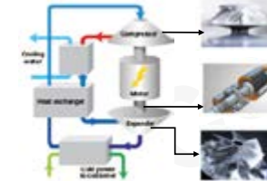
Cycle classique d'un reverse Turbo-Brayton
