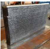
Eprouvette réalisée en WAAM
