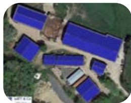
Figure 2 : Rendu 2D d'un projet de centrale PV en recouvrement de bâtiments agricoles
