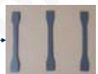
Éprouvettes de traction en colle conformes à la norme après découpe à l'emporte-pièce
