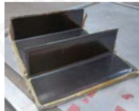
Panneau 2 raidisseurs auto-raïdi pour tests à petite échelle
